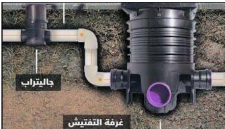
شكل رقم (٢٤) يوضح جاليتراب وطريقة توصيلة علي غرفة التفتيش
